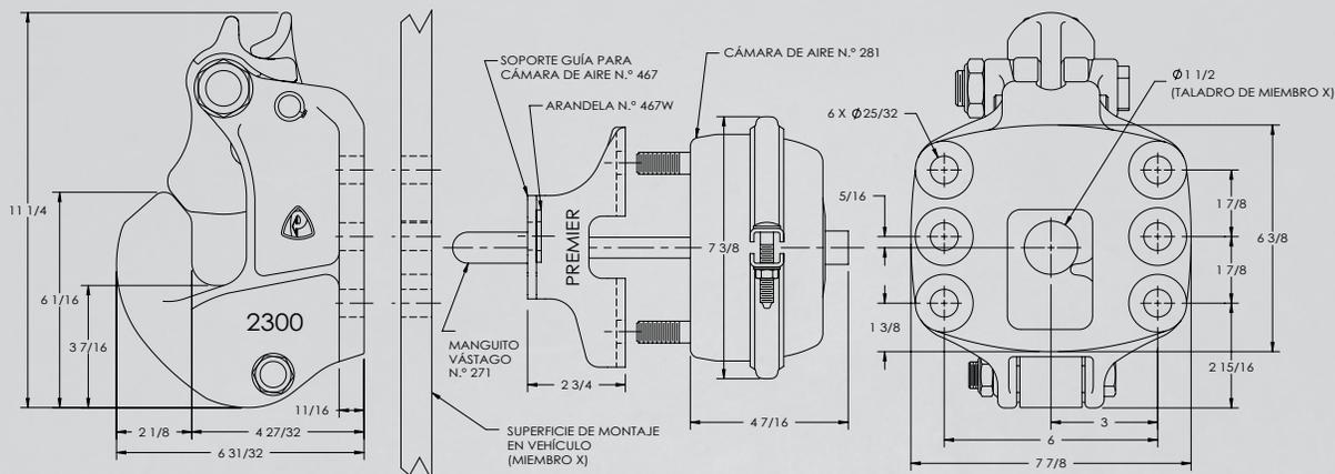
La longitud del vástago de empuje es 3 5/8 pulg. (92 mm) además de grosor de la estructura de montaje para instalaciones estándares según la ilustración.
