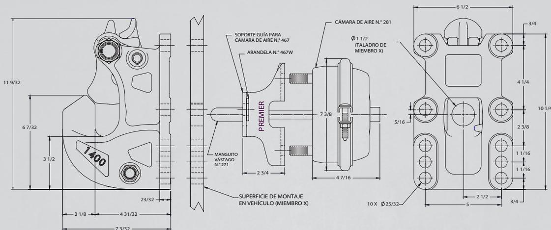
La longitud del vástago de empuje es 3 5/8 pulg. (92 mm) además de grosor de la estructura de montaje para instalaciones estándares según la ilustración.
