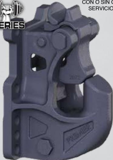
El **NUEVO 1400** reemplaza al 100-4 descontinuado usado en aplicaciones de servicio pesado. Utilizando la última tecnología, los ingenieros redujeron el peso mientras aumentaban la dureza de la superficie y elevaban la capacidad del seguro principal a 60,000 lbs..
