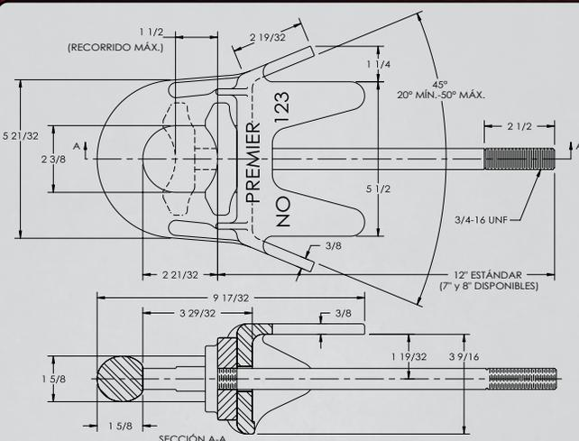
Diseñado para: Canal estándar o tubería cuadrada de 3 pulg. (76 mm).
