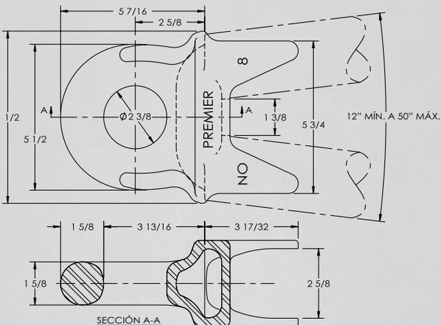
Diseñado para: 2 1/2 pulg. (64 mm) tubo redondo.
