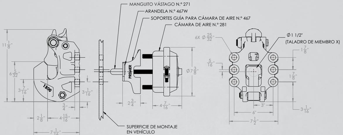
La longitud del vástago de empuje es 3 5/8 pulg. (92 mm) además de grosor de la estructura de montaje para instalaciones estándares según la ilustración.
