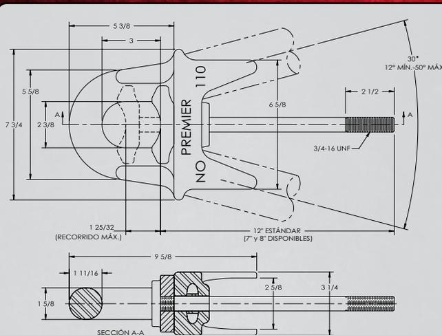
Diseñado para: Tuberías redondas de 2 1/2 pulg. (64 mm).
