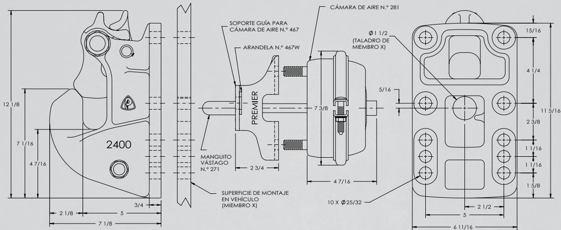
La longitud del vástago de empuje es 3 5/8 pulg. (92 mm) además de grosor de la estructura de montaje para instalaciones estándares según la ilustración.
