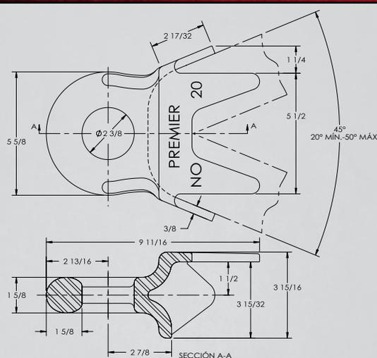
Diseñado para: Canal estándar o tubería cuadrada de 3 pulg. (76 mm).
