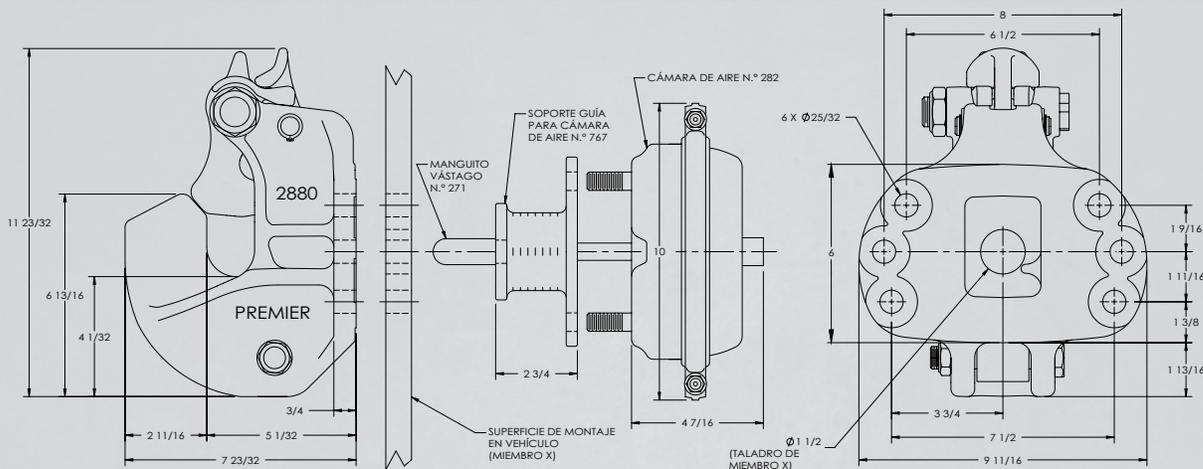
La longitud del vástago de empuje es 3 3/4 pulg. (95 mm) además de grosor de la estructura de montaje para instalaciones estándares según la ilustración.
