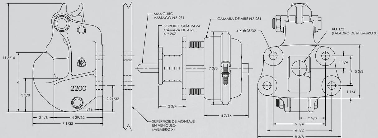
La longitud del vástago de empuje es 3 5/8 pulg. (92 mm) además de grosor de la estructura de montaje para instalaciones estándares según la ilustración.
